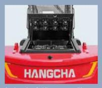
Système de refroidissement ventilé intégré afin de refroidir les composants électriques. Le capot s'ouvre entièrement pour en faciliter l'accès.
