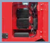
Une trappe d'accès de chaque côté du chariot permettent d'intervenir facilement sur les organes principaux comme par exemple, les variateurs, les moteurs de pompes etc...
